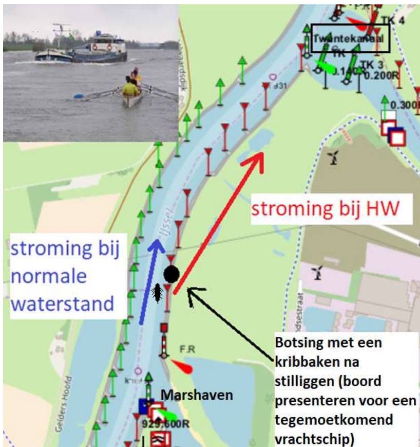
Figuur 4: Afwijkende stroming bij hoogwater - meer kans op een aanvaring met een kribbaken
